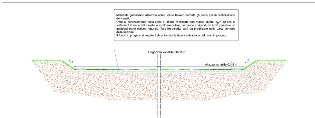
Sezione di canale tipo scala 1:100
